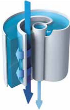
RO 멤브레인 카트리지 내에서 물의 흐름을 알 수 있는 평면도. Tangential flow는 멤브레인이 막힐 가능성을 줄여줍니다.
